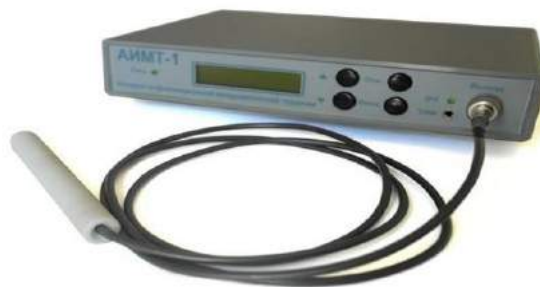
Рисунок 1 – Устройство моделирования микроволнового излучения Солнца в диапазоне частот (4,0-4,3)ГГц
